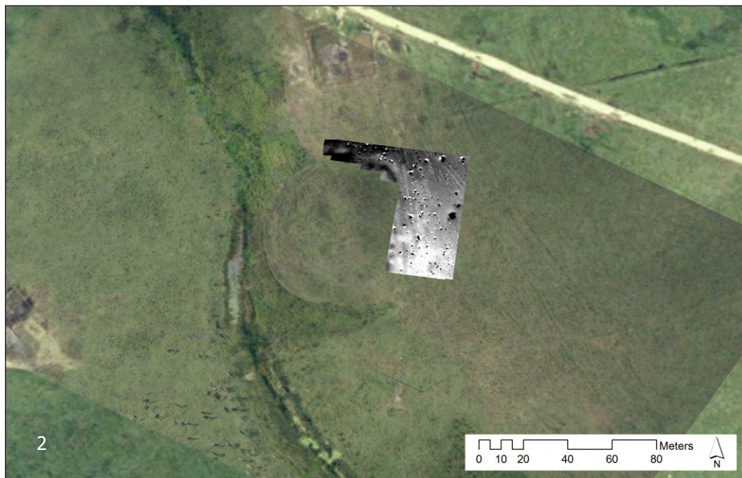
Fig. 13. Vătași Măgura. Magnetometrical map (black&white, -20+20nT) (1) over the aerial georeferenced photography (2). Vătași Măgura. Harta magnetometrică (alb-negru, -20+20 nT) (1) suprapusă peste fotografia aeriană georeferențiată (2).
